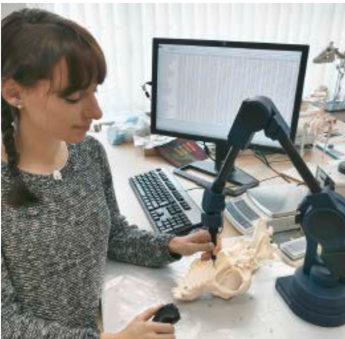
Abbildung 2: Schädelmessung mit Hilfe eines 3-D-Digitalisierers und Übertragung der Koordinaten auf den Rechner.
