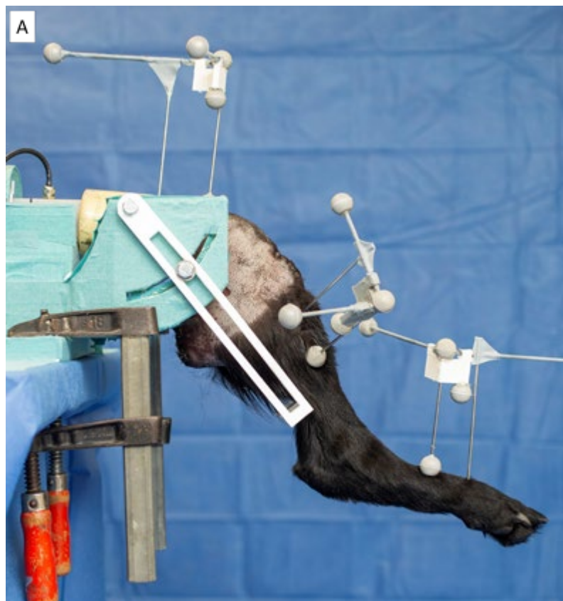
Abb. 2: Versuchsaufbau mit einer Gliedmasse in der speziell angefertigten 3D-Vorderansicht.
